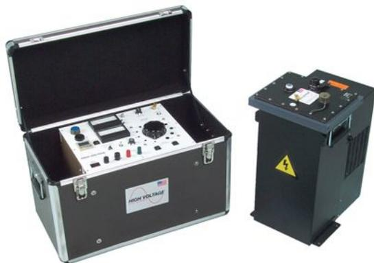
Эта модель, имеющая пиковое значение выходного напряжения 40кВ, предназначена для испытаний кабелей класса до 25кВ. Ее способность работать на нагрузку с большой емкостью позволяет испытывать приблизительно до 16 км кабеля в зависимости от типа. Установка имеет измеритель тока заряда и емкости нагрузки, а также киловольтметр выходного напряжения с нулем посередине шкалы. В комплектность также входит:
